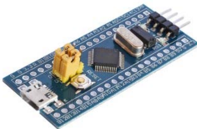
Рисунок 3 — Главный МК на отладочной плате (STM32F103C8T6)
